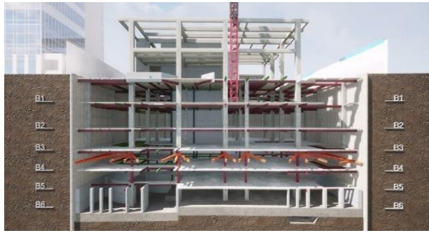
Рис. 6. Поперечний розріз підземної частини будівлі
